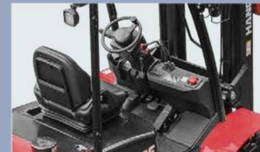
2. L'extra spazio per i piedi migliora le condizioni di guida dell'operatore, lo scalino antiscivolo rende la salita e la discesa semplice e sicura. Il volante riprogettato, il nuovo sistema di frenata e le leve facili da usare offrono una migliore esperienza di guida.
