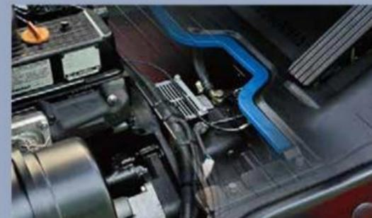
1. In aggiunta all'ammortizzatore di gomma tra il telaio e l'asse sterzante, l'ammortizzatore del motore e l'assale flottante garantiscono una connessione flessibile tra il telaio e il sistema di guida, come risultato, le vibrazioni in movimento e le vibrazioni dal sistema di guida sono significativamente ridotte.
