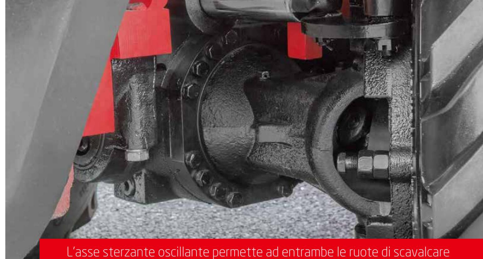
L'asse sterzante oscillante permette ad entrambe le ruote di scavalcare gli ostacoli mantenendo stabili il carrello e il carico.
