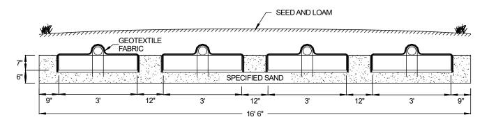
FIGURE 11: PLAN VIEW – STEP DOWN BED – PARALLEL DISTRIBUTION
