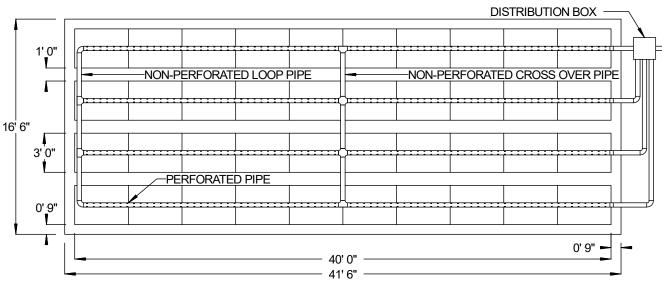
FIGURE 9: PLAN VIEW – BED SYSTEM EXAMPLE – LEVEL SITE
