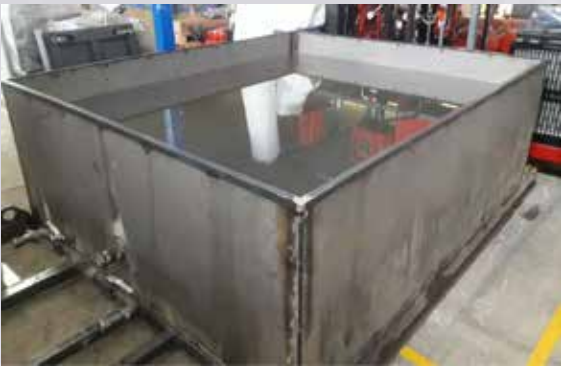
Trasvase terminado. Prueba de estanqueidad de dique de contención.
