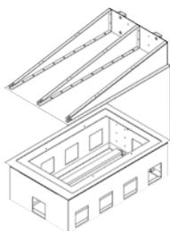
TRILATO CLASSICO è un biocamino da incasso con sviluppo a “penisola” pensato per separare con eleganza due ambienti. La struttura è un monoblocco autoportante da rivestire. L'apertura permette una visione della fiamma a 180°. Il fuoco è visibile da tre lati e da ogni angolazione della stanza. Equipaggiato con bruciatore manuale 60 nero, imbuto di caricamento e accenditore. Finitura nero.
