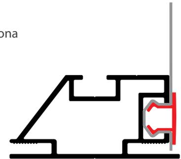
Montaje 1 cara textil con LED en el fondo.
