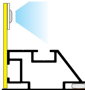
Montaje 1 cara textil con LED perimetral
