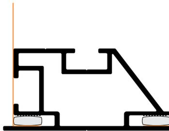
Montaje con frontal de lona tensada con junquillo Ecoflex
