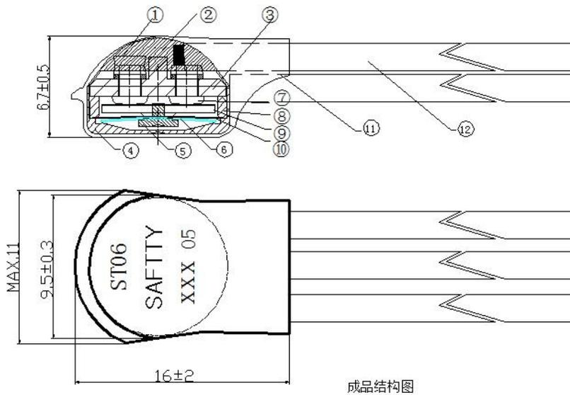
注：该厚度值 6.7 为使用 UL1332 AWG18 直径为 1.85mm 的导线的产品；如需要特定线材，产品的厚度测量值会改变。
