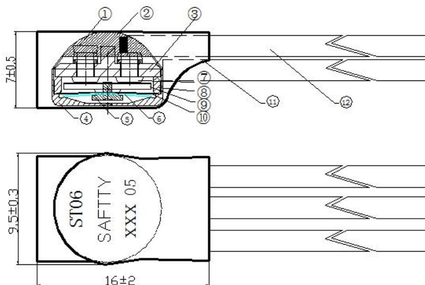
注：该厚度值 7 为使用 UL10362 AWG18 直径为 1.75mm 的导线的产品；如需要特定线材，产品的厚度测量值会改变。
