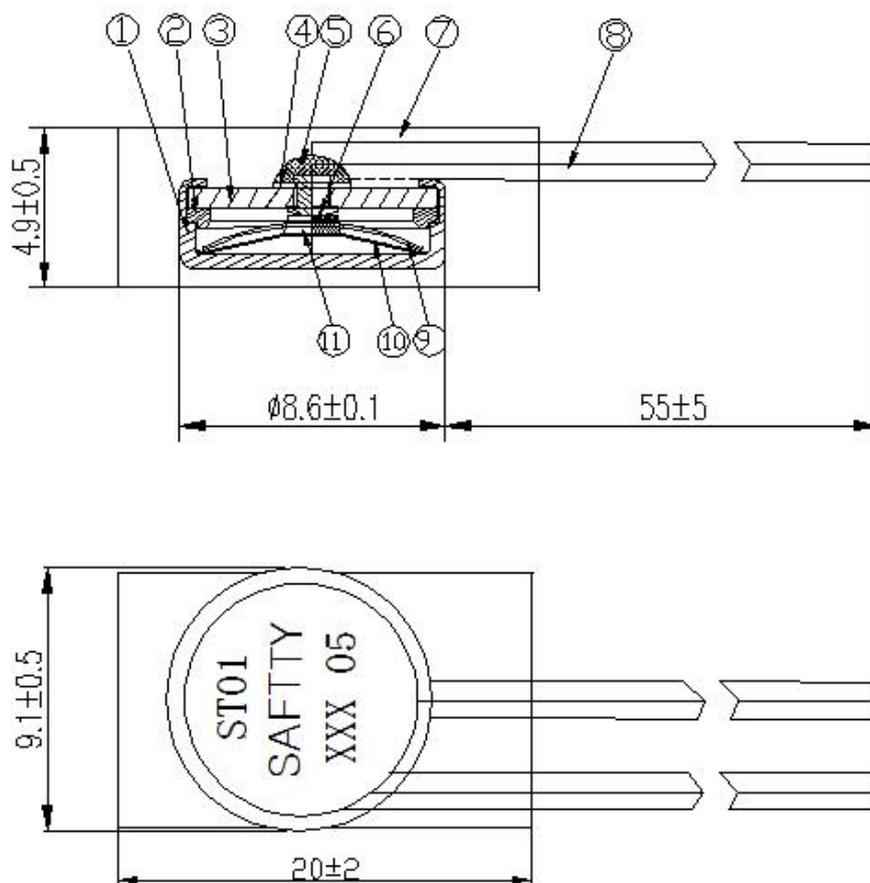
注：该厚度值 4.9 为使用 UL10362 AWG22 直径为 1.35mm 的导线的产品；如需要特定线材，产品的厚度测量值会改变。
