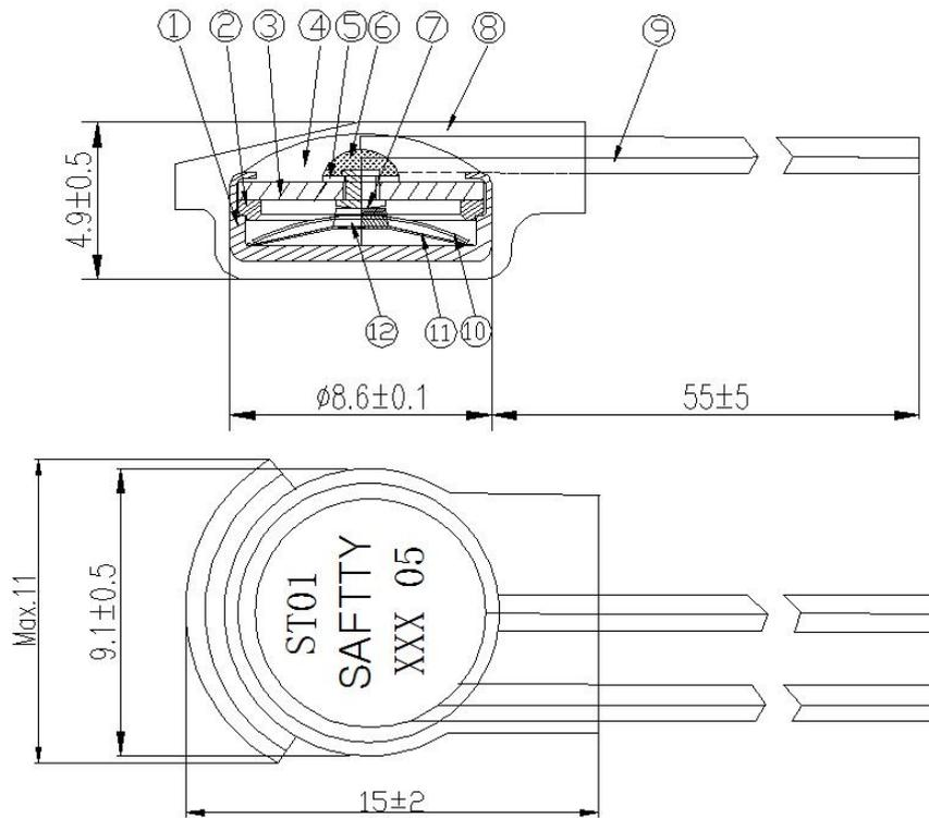
注：该厚度值 4.9 为使用 UL10362 AWG22 直径为 1.35mm 的导线的产品；如需要特定线材，产品的厚度测量值会改变。
