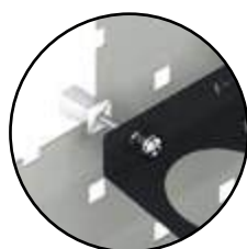
FISSAGGIO SU PANNELLO FORATO
