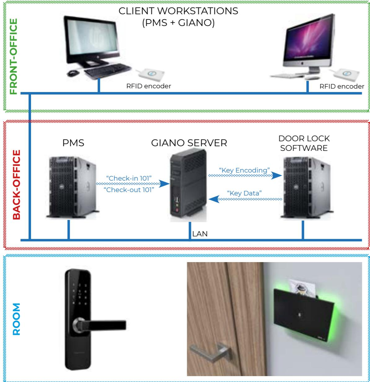
Determinati modelli di serrature elettroniche sono dotati di tecnologia wireless per **condividere il proprio stato e gli eventi in tempo reale con la domotica di camera**, la quale si occuperà di raccoglierli e portarli sul software.
