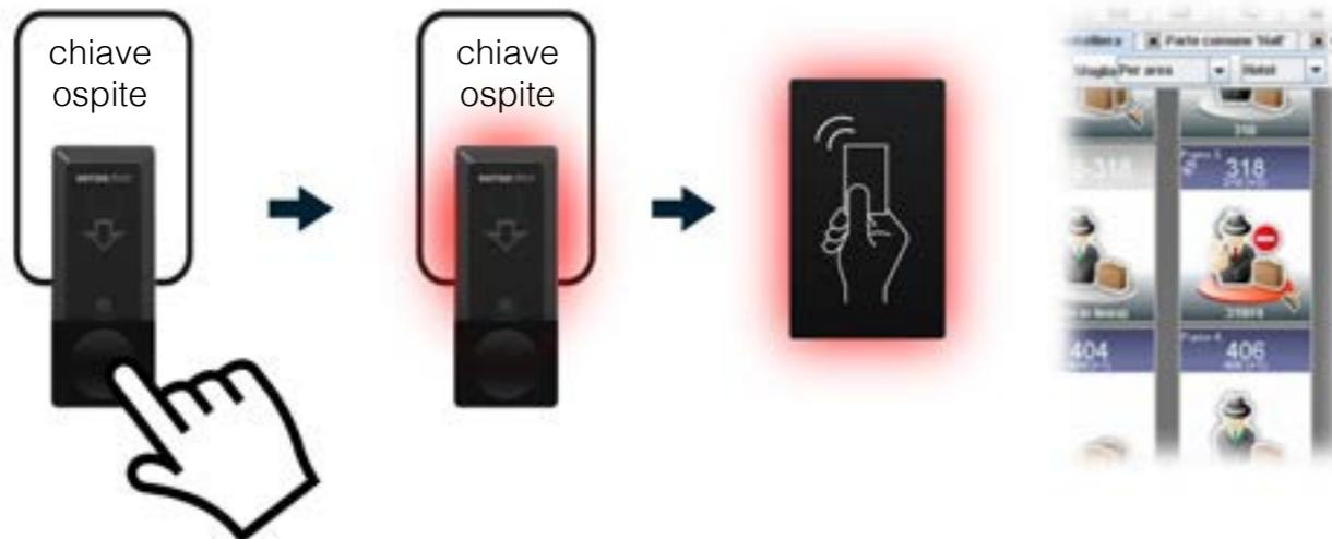
Se si inserisce una chiave RFID di livello **Ospite**, il pulsante multifunzione, una volta premuto, attiverà la modalità **“Non Disturbare”** facendo diventare **rosso** il lettore.
