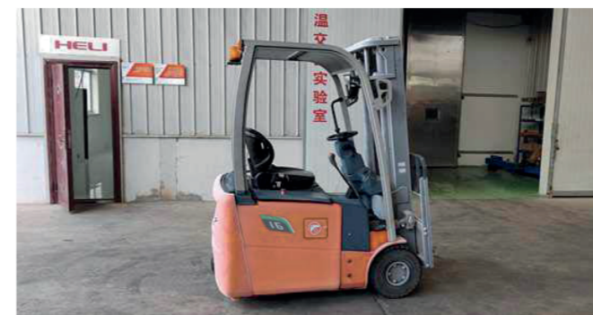
PROVA DI CONSERVAZIONE A FREDDO L'intero carrello è stato utilizzato alternativamente in una cella frigorifera a -20 °C per 6 ore e parcheggiato nella cella frigorifera per 12 ore. L'intero carrello non ha avuto problemi e ha potuto funzionare ininterrottamente
