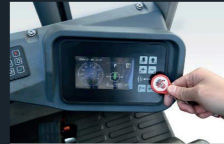
La funzione integrata di scorrimento della carta dello strumento soddisfa i requisiti di TSG 81.
