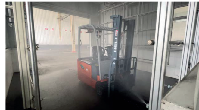
PROVA DELLA PIOGGIA il carrello raggiunge il livello di protezione IPX4 dopo aver simulato il funzionamento sotto un temporale di 15 minuti e soddisfa i requisiti di funzionamento all'aperto.
