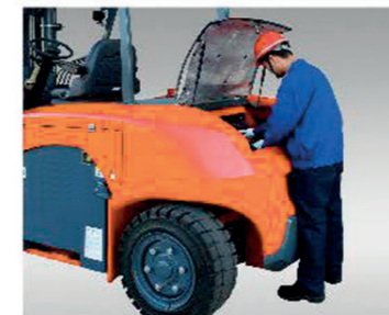
Comoda altezza di lavoro con vano di controllo elettronico e perno di trazione bloccabile
