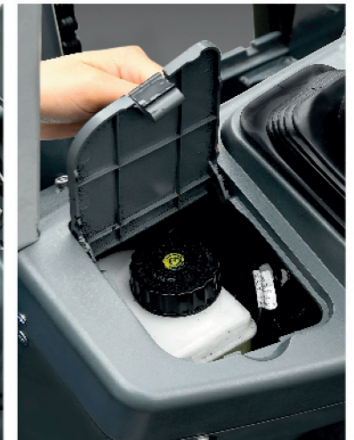
Liquido freni a portata di mano, facile da controllare e rabboccare.
