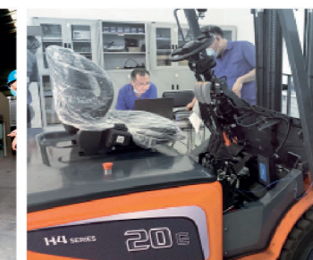
Test di vibrazione del carrello La frequenza di vibrazione dell'intero carrello viene testata per ottimizzare e migliorare il comfort operativo.
