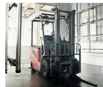
Test della pioggia Simula l'operazione sotto un temporale di 15 minuti, raggiunge il grado di protezione IPx4 e soddisfa le esigenze di funzionamento all'aperto.
