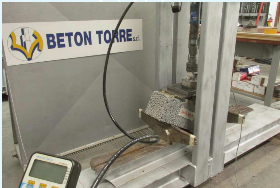
Fotografia di un provino al termine della prova di flessione.
