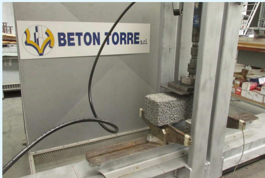
Fotografia di un provino durante la prova di flessione.
