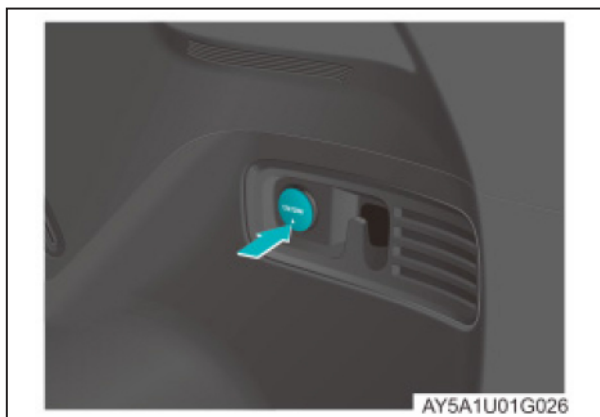
Interface de fonte de alimentação de 12V do compartimento de bagagem
