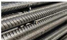
Aceros de refuerzo para concreto
