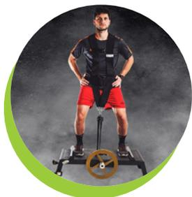
Durante la fase concéntrica del ejercicio, el músculo se contrae a la fuerza máxima posible, tirando de un cinto, el cual se enrolla en un eje del volante (contrapeso) y poniéndolo en rotación a una alta velocidad, por virtud de su inercia el volante continúa rotando y volviendo a enrollar el cinto en una dirección opuesta y de esta manera comienza la consiguiente fase excéntrica.
