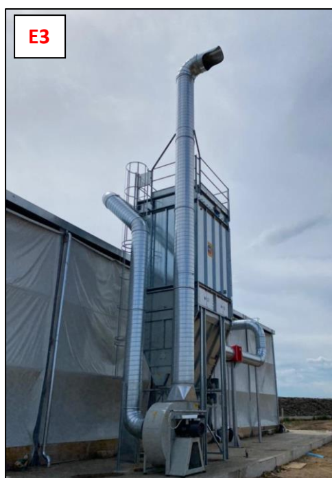
Figura 16: Filtra a manica, per il trattamento dell'aria durante la vagliatura
