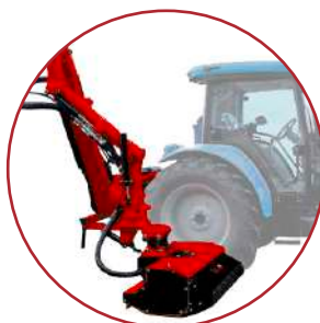
Braccio con snodo per taglio avanzato Arm with joint for advanced cutting
