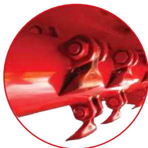
Mazze Ø19mm Hammer Ø19 mm
