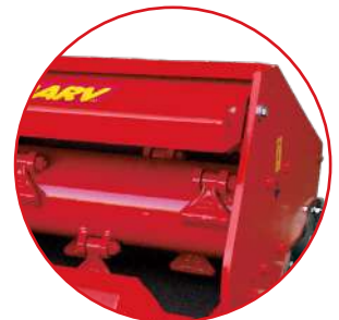
Cofano posteriore apribile Openable back door
