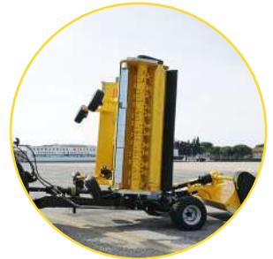
Macchina chiusa per trasporto su strada Closed machine for road transport
