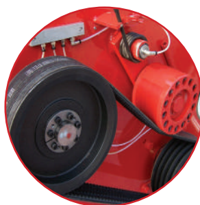
Ingrassaggio centralizzato Centralised greaser
