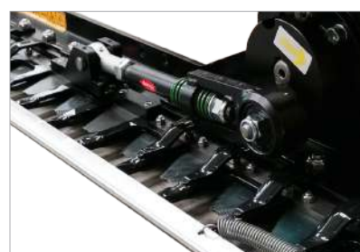
Sistema antiurto a molle Collision shock absorber
