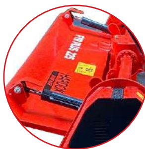
Doppio cilindro apertura cofano Double cylinder rear door
