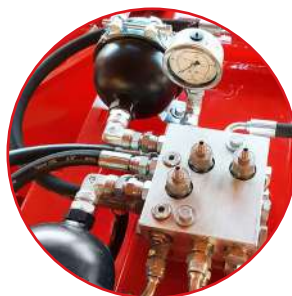
Blocco valvole di sequenza Sequence valve block
