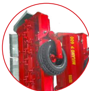
Macchina chiusa per trasporto su strada Closed machine for road transport
