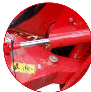
Regolazione di taglio Cut adjustment
