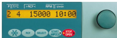
Il display e tutti i controlli sulle centrifughe MIKRO 200 e 200 R sono stati progettati per la miglior facilità d'uso. Le informazioni sul displays sono posizionate con chiarezza e perfettamente leggibili. Durante la centrifugazione i valori dei parametri effettivi vengono indicati. La combinazione dei parametri registrati rimangono nella memoria della centrifuga anche se questa viene spenta.
