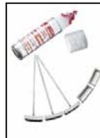
I singoli piatti di supporto del rotore 2076 sono facilmente pulibili e sostituibili in caso di rottura del capillare.
