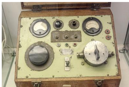
Panel de control de un equipo de primeras generaciones para tratamiento de terapia electroconvulsiva.
