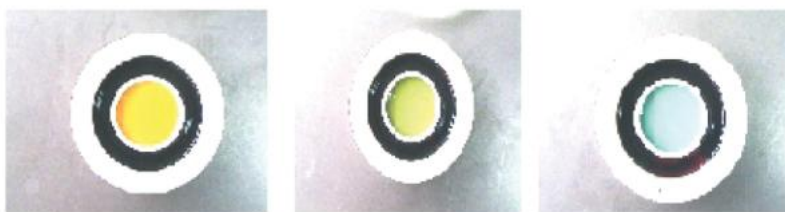
Figura 4. Determinación de alcohol etílico por microdifusión
