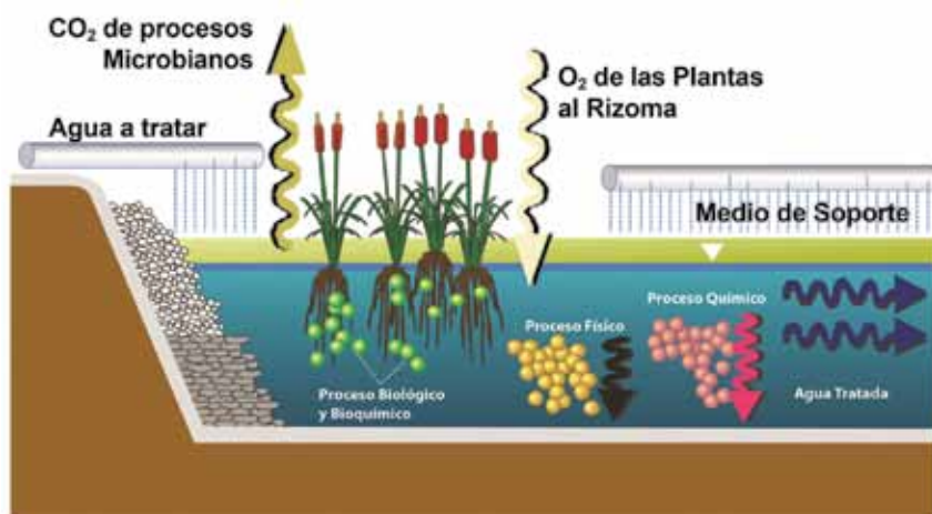
Figura 2. Principales procesos depurativos en humedales artificiales.
