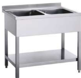
Lavello aperto con alzatina e ripiano basso senza sgocciolatoio 2 VASCHE - Struttura in acciaio inox. Top e vasca in AISI 304. Alzatina da 10 cm. Piedini regolabili. Ripiano basso, scarico, sifone e troppo pieno inclusi.
