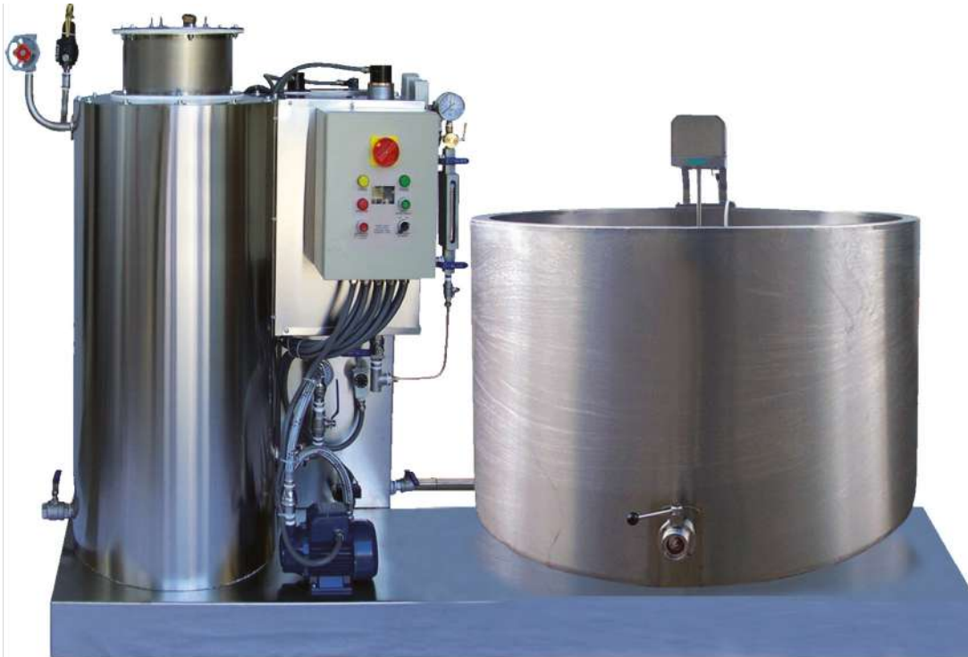
Gruppo compatto per produzione di paste filate, formaggi, ricotta
