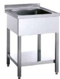
Lavello aperto con alzatina e ripiano basso senza sgocciolatoio 1 VASCA - Struttura in acciaio inox. Top e vasca in AISI 304. Alzatina da 10 cm. Piedini regolabili. Ripiano basso, scarico, sifone e troppo pieno inclusi.
