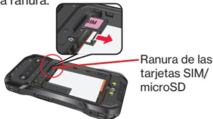
Pon la bandeja en una superficie plana y coloca una tarjeta microSD en la bandeja, con los contactos dorados hacia abajo como se muestra a continuación.
