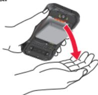
¡PRECAUCIÓN! No utiliza destornilladores ni otras herramientas a la hora de extraer la batería para no causar daños.
