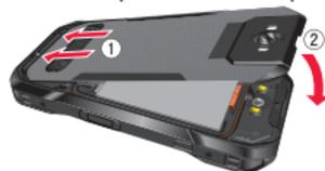
Presiona todos los costados de la tapa trasera, empezando por arriba y bajando por cada lado como indica la siguiente figura. Asegúrate de que todas las pestañas estén seguras y que no haya espacios entre la tapa y el teléfono.
