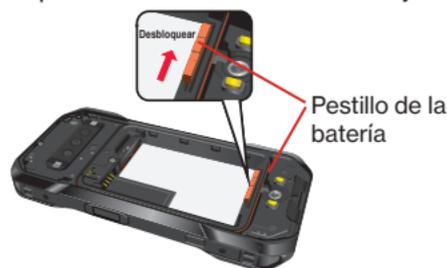
Inserta la batería y asegúrate que los contactos dorados estén alineados. Empuja suavemente la batería hacia abajo para asegurarla.
