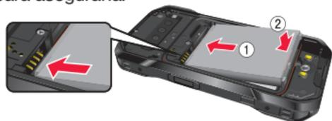
Bloquea el pestillo deslizando a la dirección que se indica la flecha en el dibujo de abajo.
