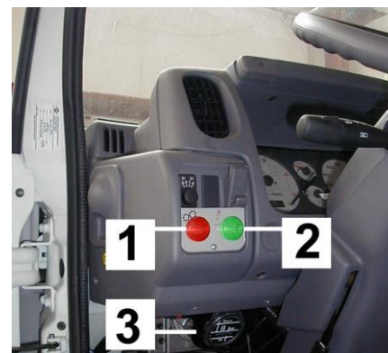
Figura 11: spia presa di forza / spia consenso alla stabilizzazione / contaore
