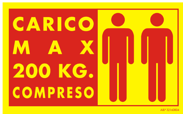
Figura 18: portata massima ammessa nel cestello
