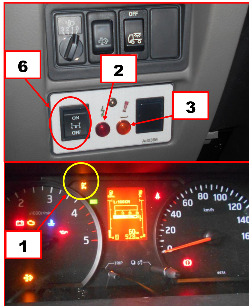
Figura 17: interno cabina autocarro (1 spia arancione su quadro: presa di forza inserita/ 2 spia verde consenso alla stabilizzazione / 3 spia gialla stabilizzatori non rientrati/ 5 contaore / 6 pulsante presa di forza)
