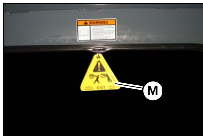
Figura 10 – Uscita di sicurezza dal finestrino posteriore
