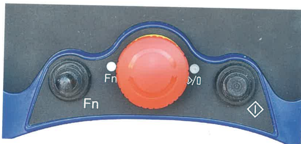
Figura 3.4 Vista del pannello d'emergenza.
