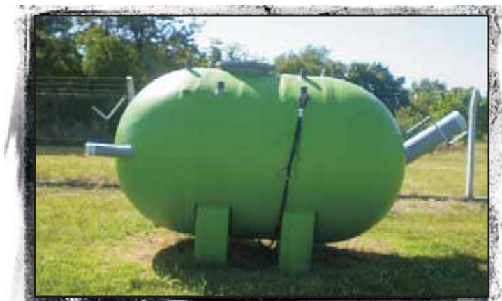
f Foto 12.13. Reactores anaeróbicos para el tratamiento de efluentes líquidos (INTA Castelar – IMyZA)
