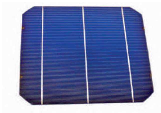
Figura: Célula de silício Monocristalino
