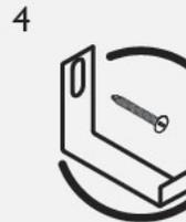
Utilice tarugos "tipo Fischer"  $\varnothing$ mínimo 6mm. Adecuados para la superficie de soporte.
