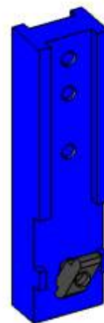
Verlängerung KM-1010-0 (-1) für Universalschwenkarm MD-3010 Bestellendnummer - 0 = Aluminium blau-eloxiert - 1 = Stahl matt-vernickelt
