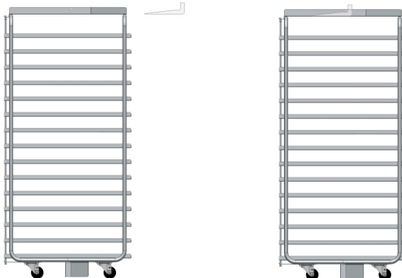
Acople del gancho rotativo del horno en el carro de alimentación
