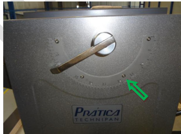
Alavanca de regulagem e escala de graduação para ajuste de espessura (abertura do rolo)
