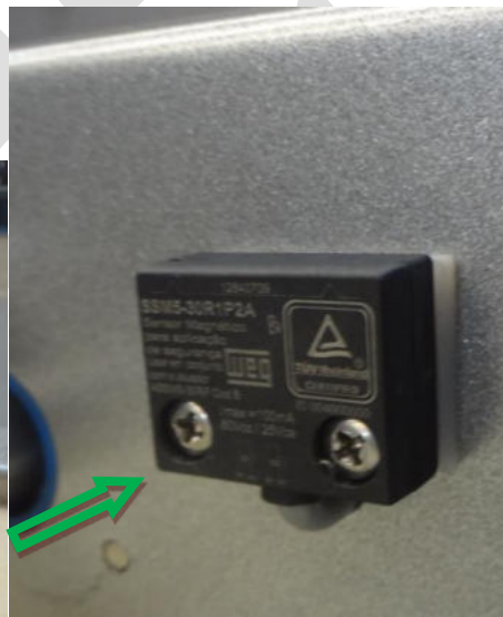
Chave eletromagnética (duplo canal) sensor SSM5-30R1PD2A e atuador ASSM5-30RP da marca WEG.
