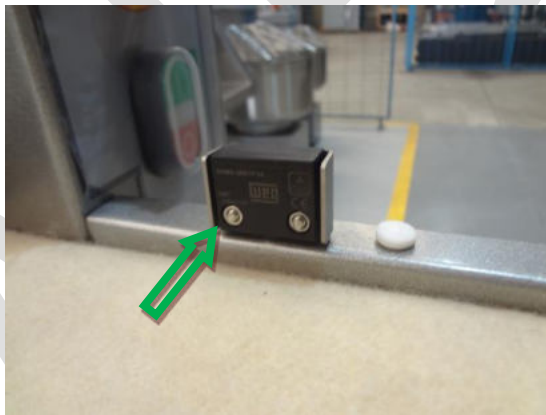
Chave eletromagnética (duplo canal) sensor SSM5-30R1PD2A e atuador ASSM5-30RP da marca WEG.
