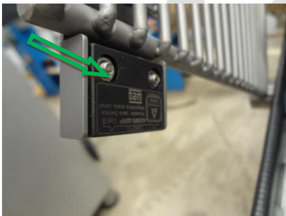
Chave eletromagnética sensor SSM5-30R1PD2A e atuador ASSM5-30RP da marca WEG.
