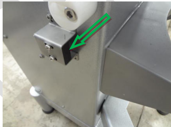
Chave eletromagnética sensor SSM5-30R1PD2A e atuador ASSM5-30RP da marca WEG.
