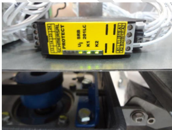
Funcionamento do relé dos dispositivos de segurança
