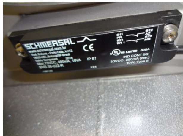
sensor BPS 36-1 e atuador da marca Shemarsal.
