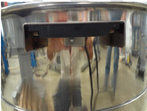
sensor BPS 36-1 e atuador da marca Shemarsal.
