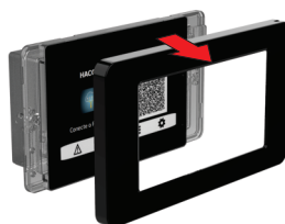
Figura 2 – Remova a moldura puxando para trás conforme a imagem.
