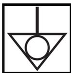
Tal parafuso é destinado a equipotencialização do seu equipamento e deve ser utilizado com a finalidade de evitar descargas elétricas ao operador do equipamento, caso toque em máquinas com cargas elétricas diferentes. A não utilização do mesmo poderá acarretar choques elétricos e danos terceiros, estes são de responsabilidade do cliente e caracterizam negligência pelo não cumprimento da norma.
