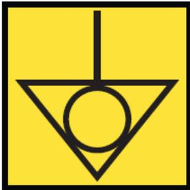
O equipamento possui um conector de interligação para outros equipamentos. Esse conector visa manter diversos equipamentos com o mesmo potencial elétrico. Não sendo necessariamente o Terra de uma ligação local. Esse conector está localizado na parte traseira do equipamento é identificado com o símbolo ao lado.
