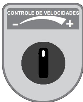
Para diminuir a velocidade: Girar a chave para a esquerda. A velocidade diminui enquanto a chave for segurada nessa posição. Ao soltar a chave ela retorna ao centro e para de diminuir a velocidade.
