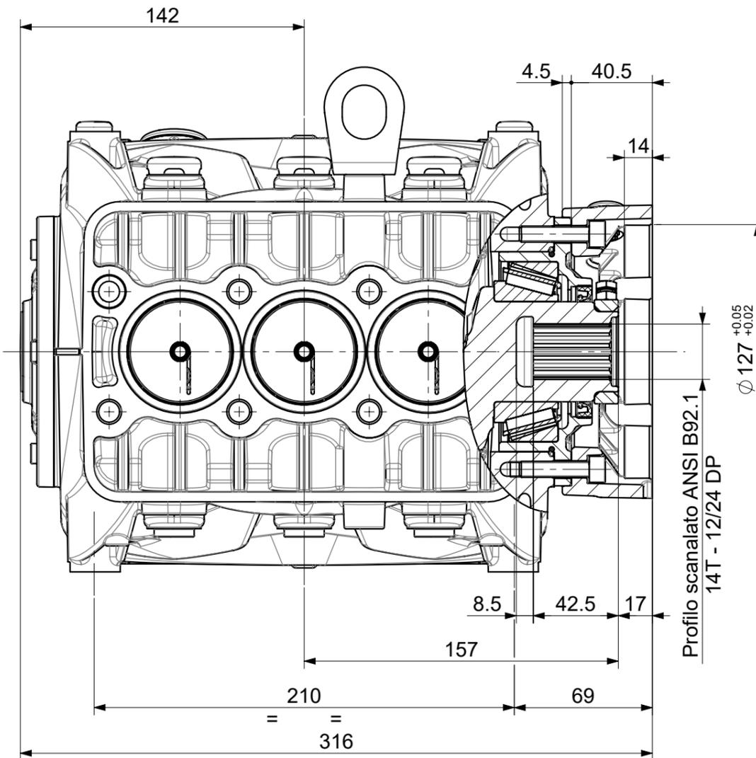
**PRESA DI FORZA DIRETTA PER MOTORE IDRAULICO
