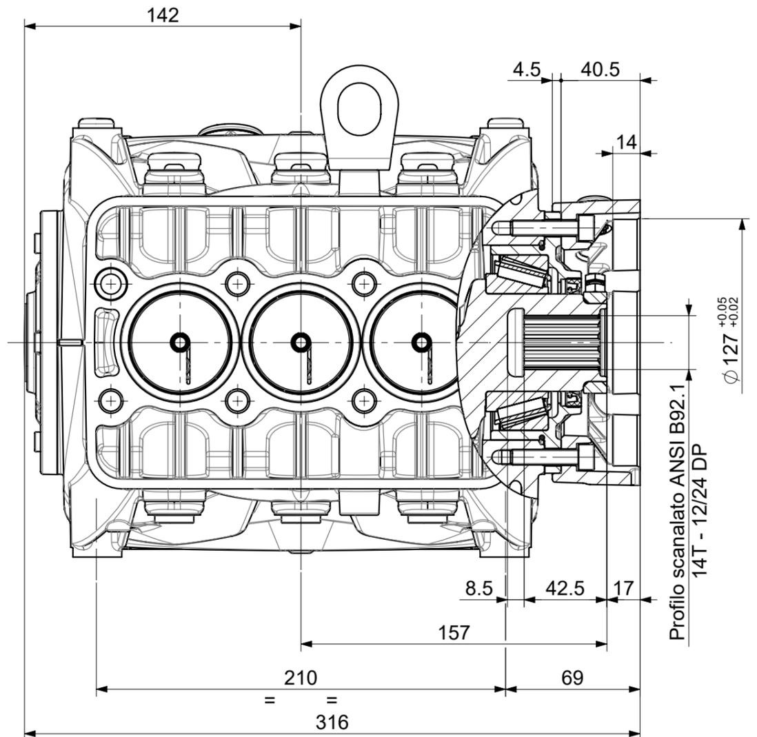
**PRESA DI FORZA DIRETTA PER MOTORE IDRAULICO
