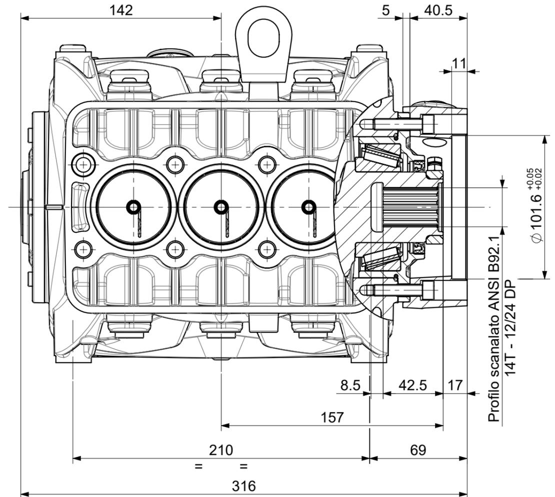
**PRESA DI FORZA DIRETTA PER MOTORE IDRAULICO
