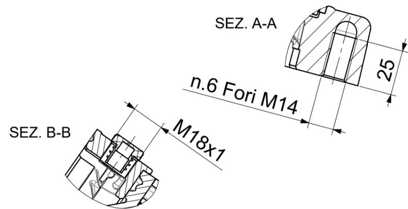
**PRESA DI FORZA DIRETTA PER MOTORE IDRAULICO
