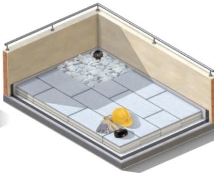
**8.** Il deflusso delle acque piovane avviene su due livelli: quello sotto il pannello isolante e per la maggior parte, sopra il mattone. Creare, in prossimità dei bocchettoni di scarico, un pozetto di 40x40 (cm), e aver cura che gli scarichi siano sempre efficienti...
