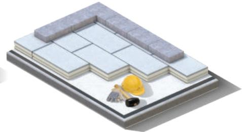
**9.** Nel caso in cui la superficie di posa non sia dotata di un parapetto perimetrale, si raccomanda di posizionare della zavorra secondo la normativa UNI11442:2015 (Criteri per il progetto e l'esecuzione dei sistemi di coperture continue - Resistenza al vento)
