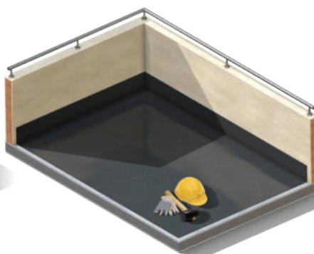
**2.** Verificare l'integrità ed eventualmente ripristinare l'impermeabilizzazione esistente. Realizzarla in caso di assenza.
