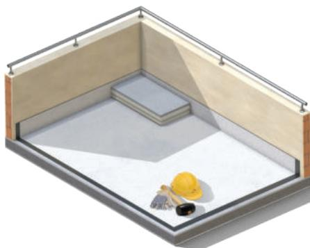
**4.** Posare il pannello isolante ISOLmat XPS sul geotessile.
