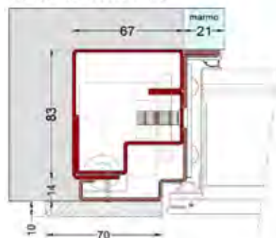
ANTA E MOSTRA A FILO: TELAIO F13G - SOLUZIONE 2
