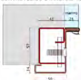
DI SERIE: TELAIO F10 CONTROTELAIO STANDARD 41
