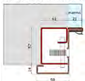
DI SERIE: TELAIO F10 CONTROTELAIO STANDARD 41
