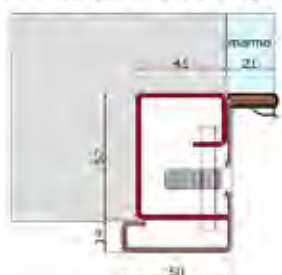
DI SERIE: TELAIO F10 CONTROTELAIO STANDARD 41
