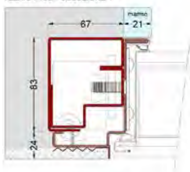
ANTA A FILO INTONACO: TELAIO F13G - SOLUZIONE 1
