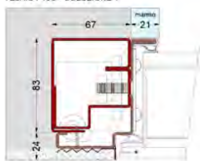
ANTA A FILO INTONACO: TELAIO F13G - SOLUZIONE 1
