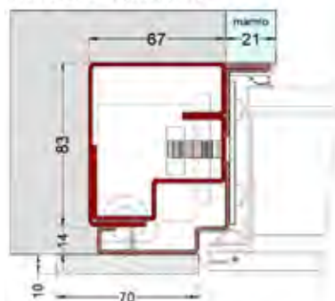
ANTA E MOSTRA A FILO: TELAIO F13G - SOLUZIONE 2
