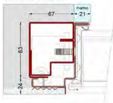
ANTA A FILO INTONACO: TELAIO F13G - SOLUZIONE 1
