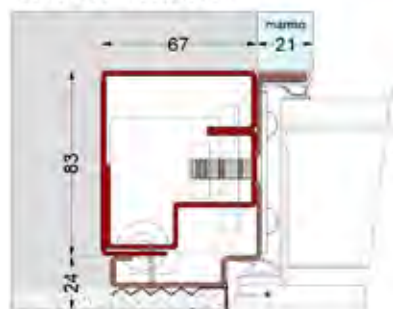
ANTA A FILO INTONACO: TELAIO F13G - SOLUZIONE 1
