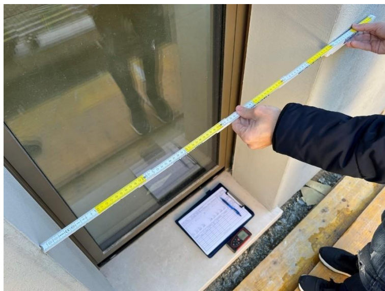
Esempio di rilievo misura architettonica della LARGHEZZA
