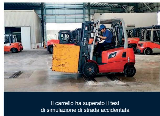
Il carrello ha superato il test di simulazione di strada accidentata
