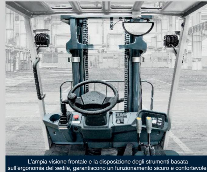
L'ampia visione frontale e la disposizione degli strumenti basata sull'ergonomia del sedile, garantiscono un funzionamento sicuro e confortevole.
