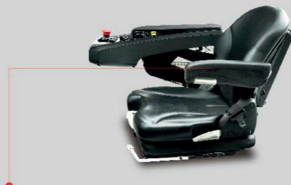
I sedili a sospensione integrale Grammer sono opzionali per una guida più confortevole. Il bracciolo multifunzionale integra interruttore a sfioramento, interruttore dello sterzo, cambio PES, pulsante clacson, interruttore di spegnimento di emergenza, ecc., facile da usare e controllo proporzionale eletromagnetico preciso.
