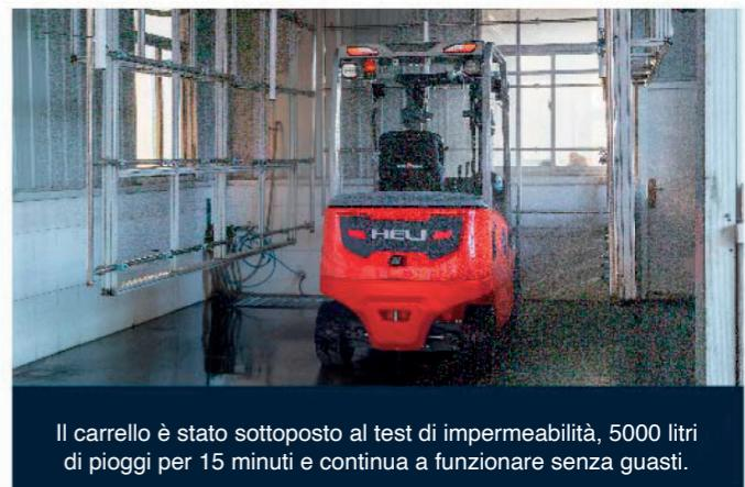
Il carrello è stato sottoposto al test di impermeabilità, 5000 litri di pioggi per 15 minuti e continua a funzionare senza guasti.
