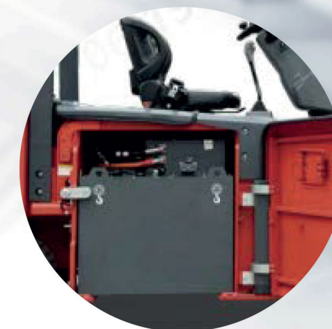
Batteria al litio ad alta capacità, modello con batteria estraibile lateralmente opzionale
