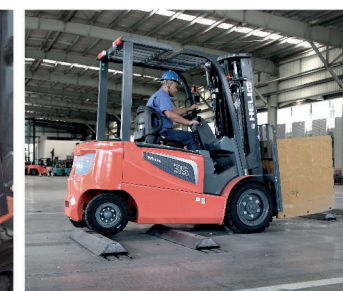
Test dell'affidabilità Rafforzamento di 800 ore dell'intero carrello (compresi arrampicata, pioggia, strada accidentata, ecc.)
