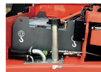
Il serbatoio dell'olio idraulico è situato sul lato sinistro per facilitare il riempimento e il controllo.
