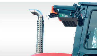
Dotato di scarico alto di serie, dal design ergonomico, anti-spruzzo d'acqua e isolamento termico.
