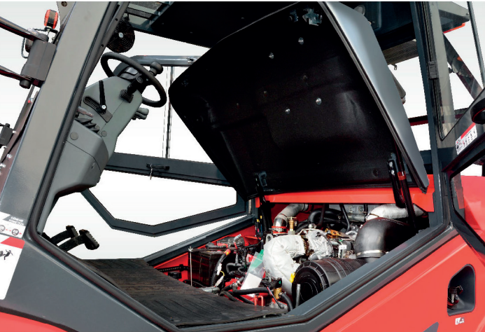
Il cofano ha un ampio angolo di apertura, migliorando notevolmente lo spazio per la manutenzione.
