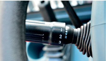
La retromarcia elettroidraulica a 3 assi anteriori e 1 posteriore è comoda e affidabile.
